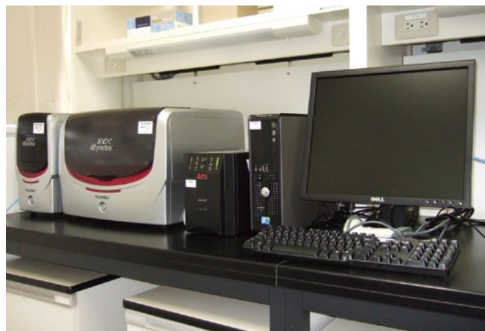
パーソナルマイクロアレイシステム。 がんなどによる遺伝子の働きの変化を解析する
