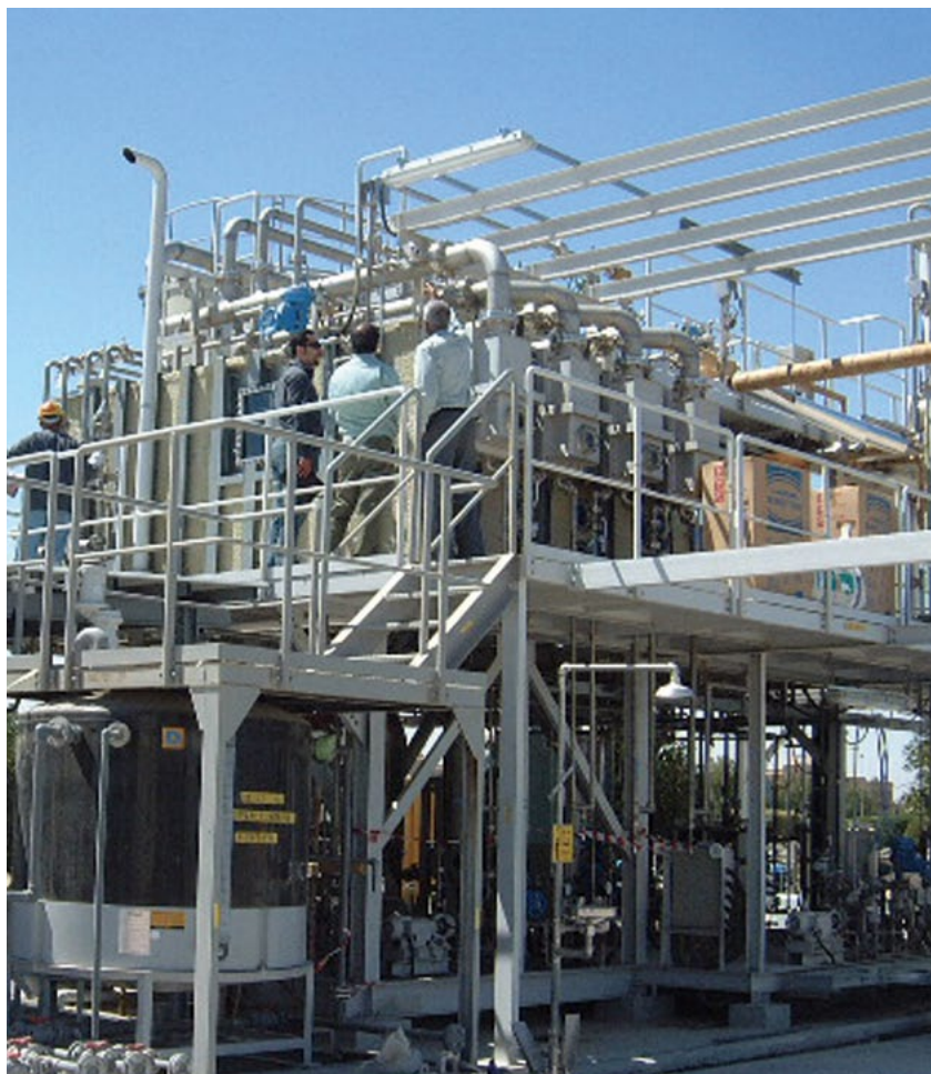
造水促進センターの技術を使ったサウジアラビアの海水淡水化装置
